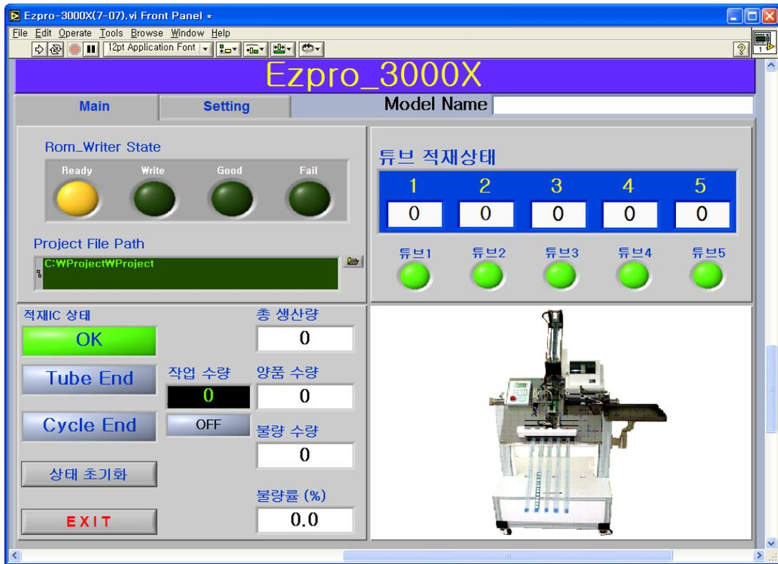
화면에 보이는 것처럼 Rom Writer의 현재 동작 상태 및 양/불 판단이 LED를 통하여 표시되며 적재 가능한 튜브가 장착되었는지 여부 또한 LED를 사용하여 표시한다. 총 생산량 및 양품수량, 불량수량, 불량률이 디지털 값으로 표현되며 각각 진행된 데이터는 자동으로 지정된 폴더에 저장된다. 입력 되는 프로그램의 변경은 Rom\_Write State 하단에 존재하는 Project file Path에 원하는 프로그램을 설정하면 자동으로 손쉽게 변경이 가능하다.
