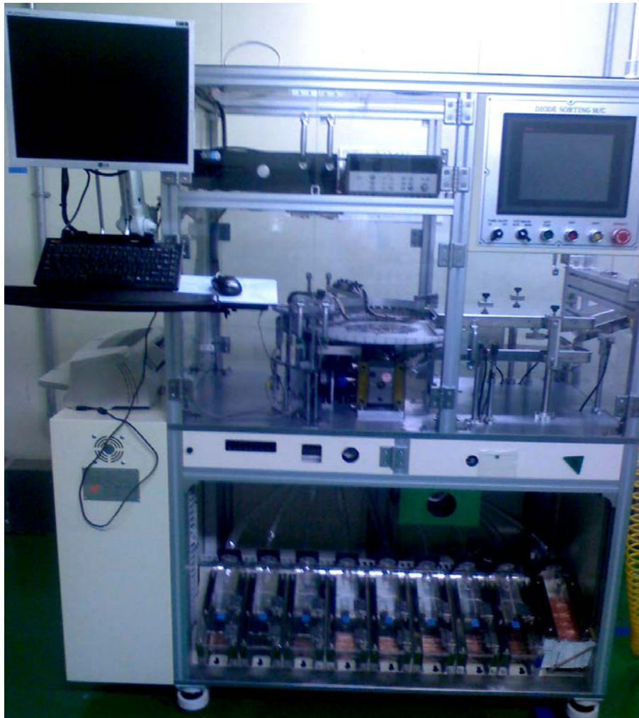
그림 2. 써미스터 저항 측정 및 분류 장치
